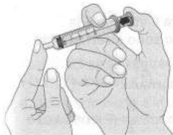
■ Fig. 4 La pressione esercitata dall'aria nella siringa cresce al diminuire del suo volume.
